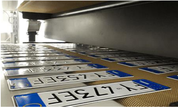
ESSICCATOIO ES IF 12,6/2000 5 PIANI - Targhe DRYER ES IF12,6/2000 5 LEVEL - Plaques
