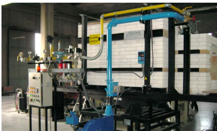
FORNO FUSORIO A BACINO BASCULANTE DA LABORATORIO LABORATORY TILTING BASIN MELTING FURNACE
